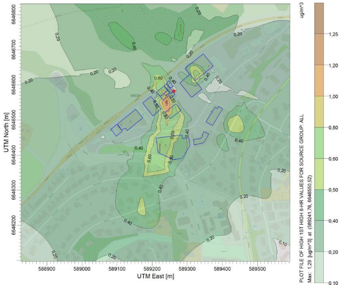
Figur 8 Maksimalt bakkekonsentrasjonsbidrag av tetrahydrofuran fra rensert prosessutslipp etter alternativ driftssituasjon - samlet fra ventilering av dedikert prosessutstyr og punktutslipp, vist i \mu\text{g}/\text{m}^3 .
