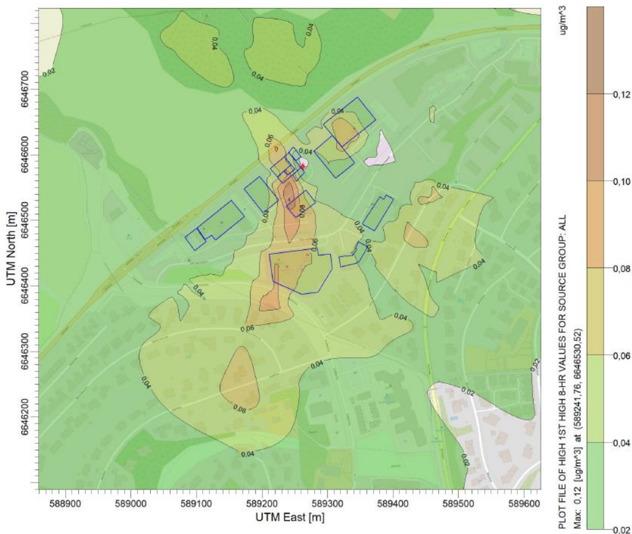
Figur 12 Bakkekonsentrasjonsbidrag av tertbutanol, µg/m 3 . Alle viste konsentrasjoner er langt under grenseverdier. Utslippspunktet med avgassrørene er vist med rødt kryss.
