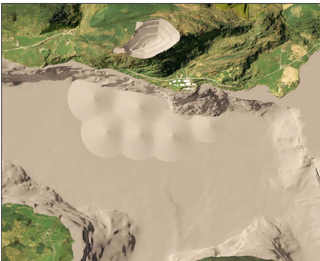
Figur 27 – Illustrasjon av deponikjegler etter 40 års drift
