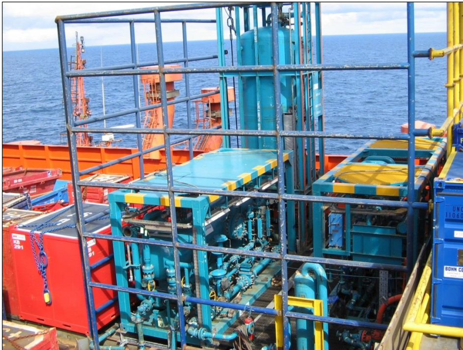
Figur 4-6. Et typisk testanlegg om bord på riggen. Beskyttelsesburet rundt anlegget benyttes for å beskytte anlegget mot kollisjoner og kranløftuhell.
